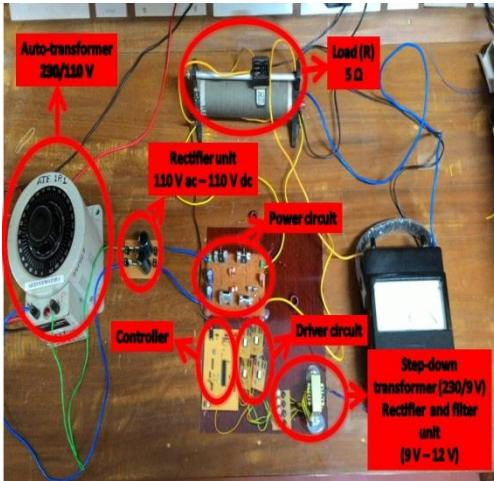
Fig. 18. Experimental setup
